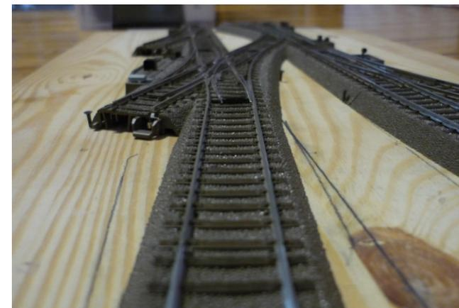
Anhand der eingezeichneten Linien wird der alte, gerade Gleisverlauf nachvollziehbar. Der verschwenkte Zungenbereich ist gut erkennbar.
