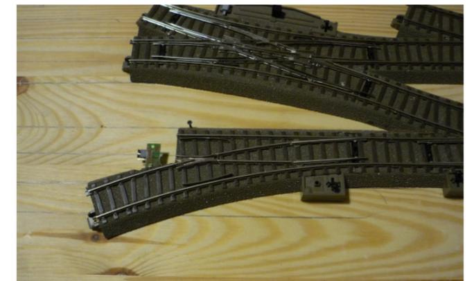
Die Weiche ist hier schon hinter dem Herzstück gekürzt. Nun kann das abgeschnittene Teil aus dem Gleis 62912 angefügt werden.
