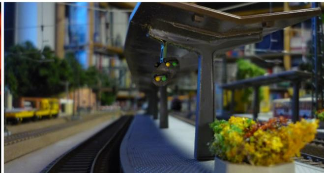
Im eingebauten Zustand hat der Vorsignalwiederholer die Aufgabe, den Lokführer über die Stellung des Ausfahrsignals zu informieren.
