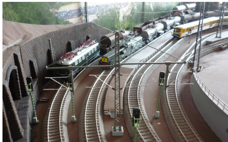
Um den Mastwald so übersichtlich wie möglich zu halten, hat sich Mario Cuva für den Selbstbau eines doppelten Rohrauslegers entschieden.
