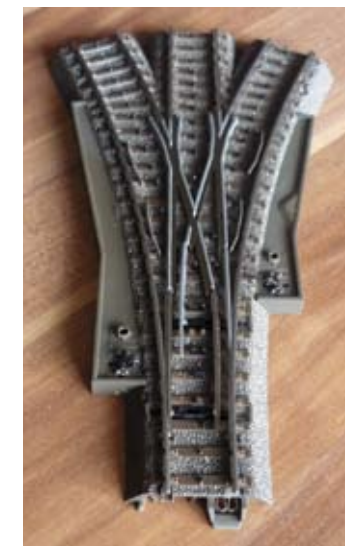
Vor dem Gleichstrom-Umbau: Die Märklin-Dreiwegeweiche 24630.
