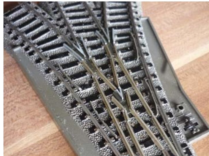
Saubere Arbeit: Die neuen Herzstücke, die aus dem Plastik-Gleiseinsatz herausgetrennt wurden, aus der Nähe betrachtet.
