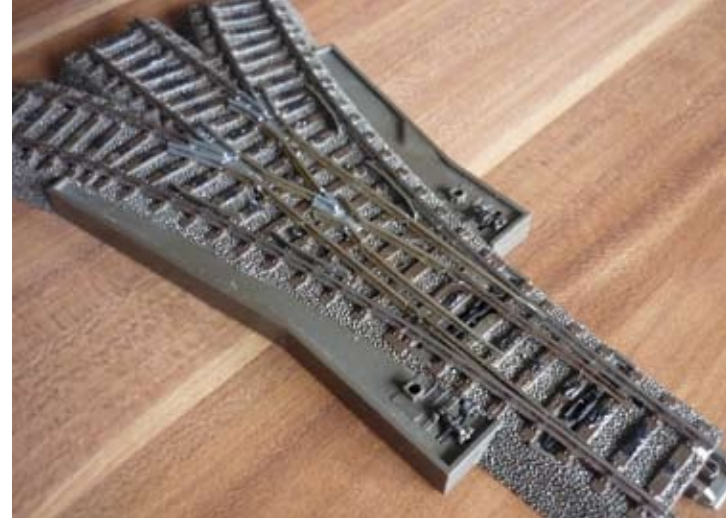
Optisch ohne Fehl und Tadel: Die Schienenstücke sind befestigt, neue Weichenzungen angefertigt und die Mittelleiter-Löcher verspachtelt.
