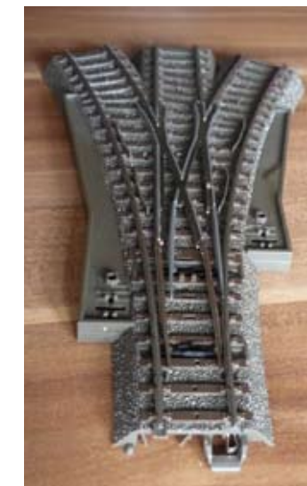
Die Weichenmechanik und der Mittelleiter wurden entfernt.
