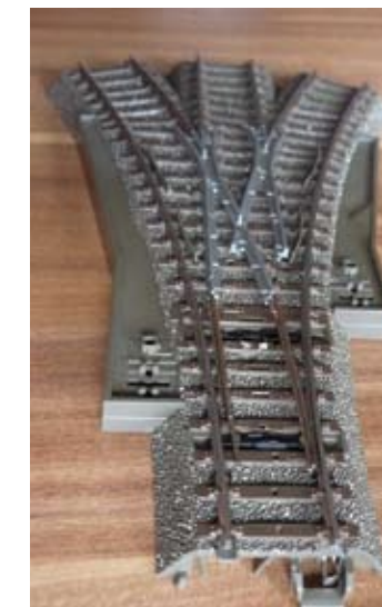
Die Weichenzungen und Blechstreifen sind demontiert.
