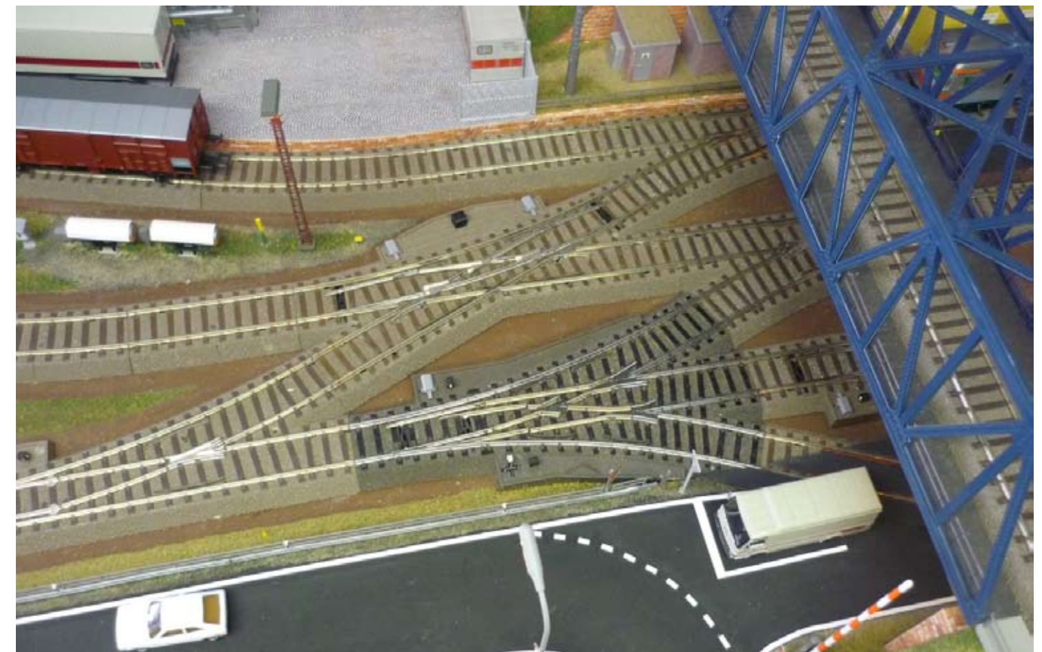
Der Aufwand hat sich gelohnt: Die selbstgebaute Dreiwegeweiche ermöglicht den gleichzeitigen Betrieb von zwei Zuggarnituren.
