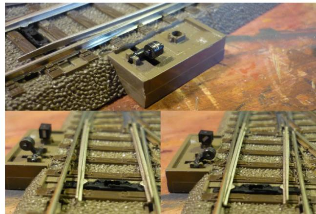
Die Weichenkästen sind eingebaut und wurden in die Mechanik der Weichen eingebunden. Danach funktionierten sie einwandfrei.
