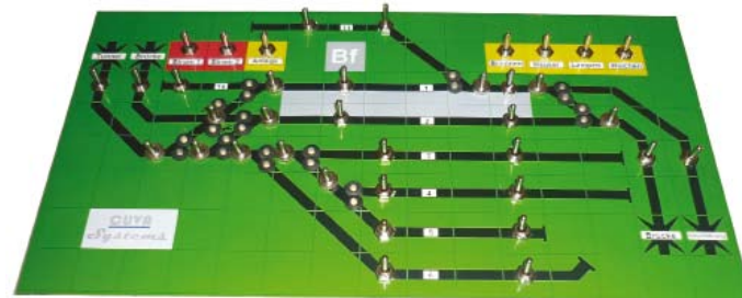
Das Stellpult Marke Eigenbau: Links sieht man die selbst erstellte Grafik, auf der rechten Abbildung die in Eigenbau gefertigte Pultplatte.
